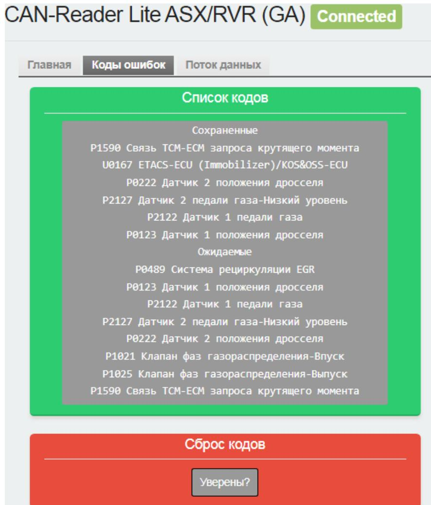
Рис.3 Коды неисправностей
